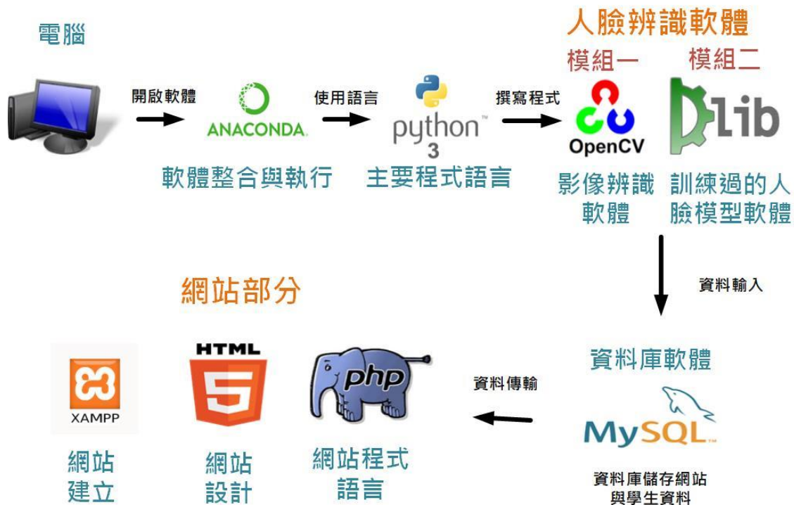
圖 3.3 軟體系統架構流程圖
