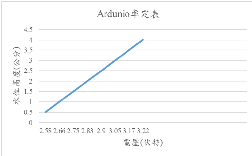
圖9 Arduino 率定曲線表
