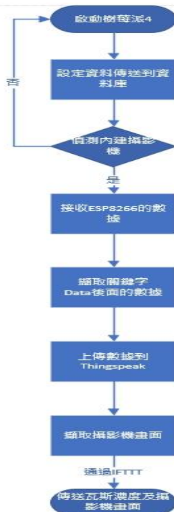
圖5.4.1 樹莓派系統流程圖
