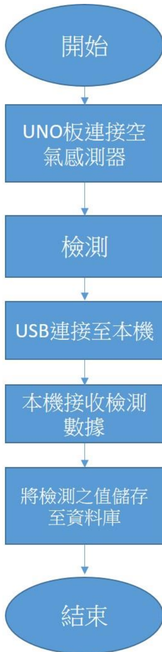
圖 3.8 「數據蒐集」子系統流程圖
