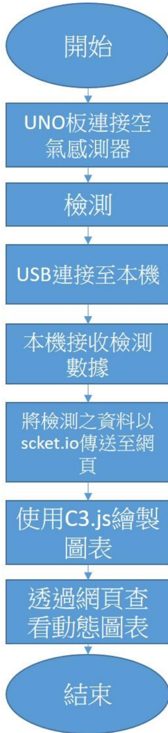
圖 3.12 「視覺化即時監控」子系統流程圖
