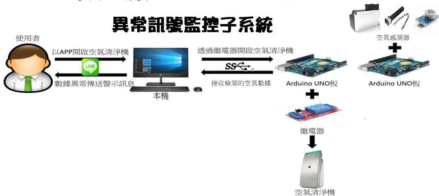
圖 3.13 「異常訊號監控」子系統架構圖
