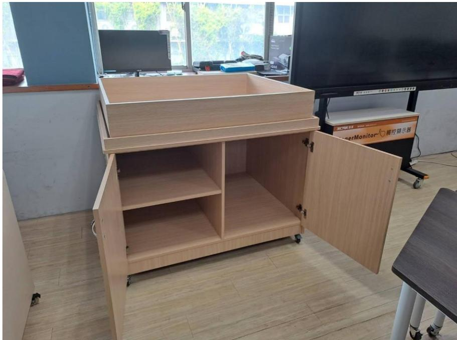
圖 3.13 沙盒基座設計成移動式滾輪及儲物櫃
